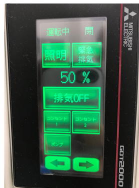
低風量型（プッシュ・プル型）超高速VAV（可変風量）式局所排気装置（操作パネル上で排気ファン出力の見える化）（水無瀬研究所）
